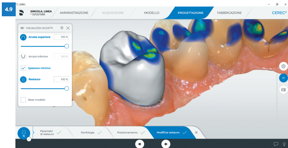
Figura 4.10 Progettazione: valutazione dello spessore minimo.
