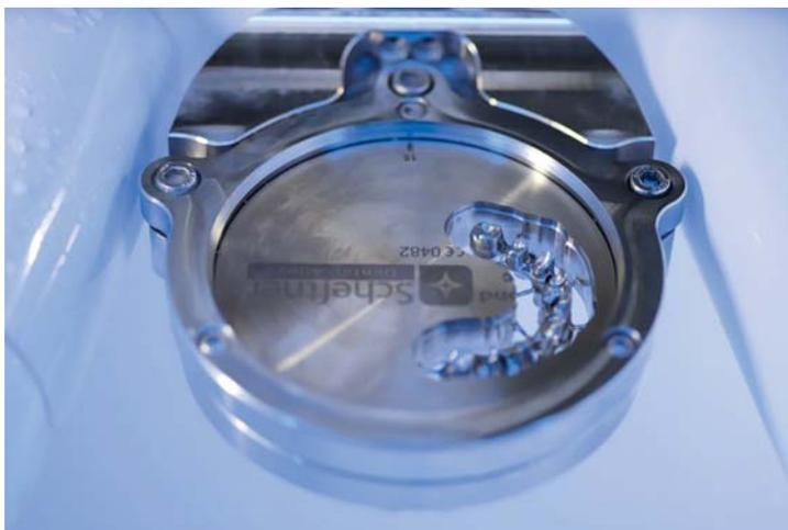
📷 1.22 Processo di fresaggio della sotto struttura di una protesi, a partire da una cialda di titanio.
